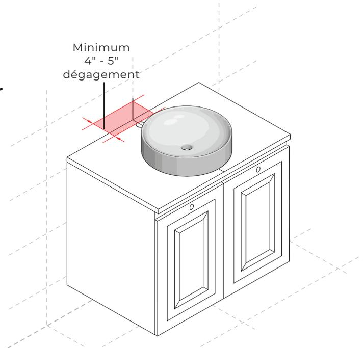
**IMPORTANT:** Pour les robinets muraux, ignorez l'exigence minimale de 4-5 pouces d'espace. Au lieu de cela, ajustez l'emplacement de l'évier pour s'adapter à la portée du robinet, en veillant à ce que le bec s'étende à une position qui empêche les éclaboussures. Suivez le guide d'installation du fabricant pour des étapes précises.
